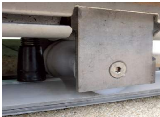
Bremse mit Gummibacke und Führungsrad
