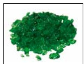
Zusätzlich zur negativen Oberflächenladung wurden katalytische Oberflächeneigenschaften für AFM entwickelt. Wird AFM zur Filtrierung von Wasser verwendet, das mindestens 1 mg/l gelösten Sauerstoff enthält, so dissoziiert das AFM das Sauerstoffmolekül und erzeugt zwei freie Sauerstoffradikale. Diese freien Radikale bieten einen gewissen Grad an Oberflächen-desinfektion und spalten dabei gleichzeitig organische Moleküle, die sich auf der Oberfläche des AFM befinden.
