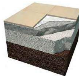
Verlegung auf Drainagemörtel
